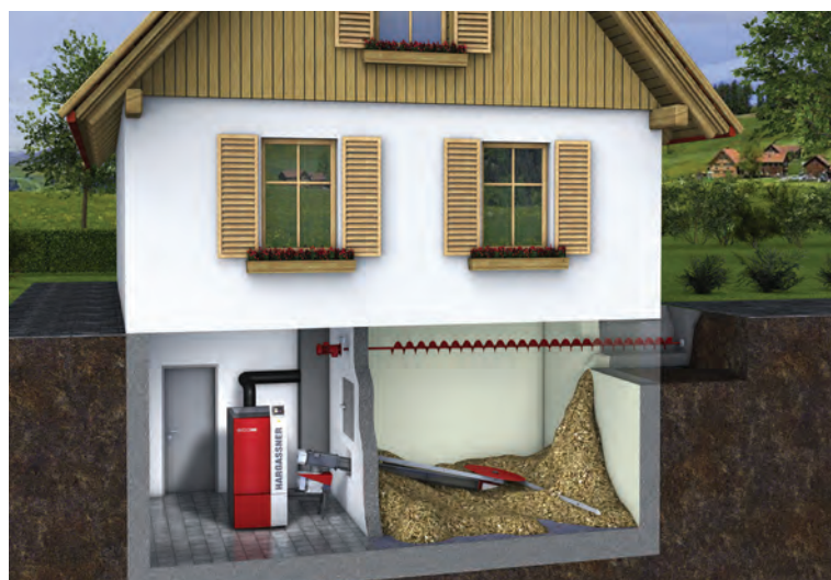
Chaudière et silo en sous-sol :
