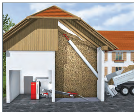
Remplissage par vis inclinée lorsque le silo est de plain-pied.
