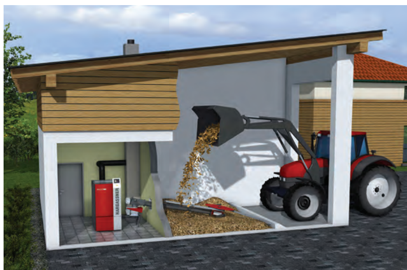
Chaudière et silo mitoyens et de plain-pied :
