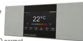
Pour chacune des zones et depuis votre habitation, le report de commande digital FR40 permet de forcer le mode confort, le mode réduit, le mode arrêt ou le mode soirée et de modifier la consigne de température de la zone. De plus, il peut être paramétré avec ou sans correction de la température d'ambiance selon la configuration de la zone concernée. Il est équipé d'un voyant rouge qui vous informe d'un éventuel défaut sur la chaudière.
