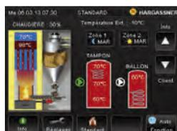
**Chaudière en fonctionnement à puissance réduite :**
